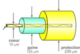
La gaine plastique est la couche extérieure du câble. Elle a un diamètre de 250  $\mu\text{m}$  (un quart de millimètre). Grâce à sa propriété isolante, elle protège les couches inférieures.
